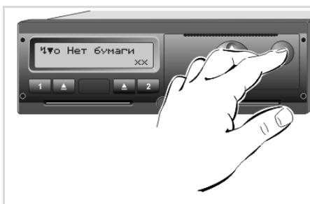
Рис. 43. Индикация при отсутствии бумаги в лотке принтера
