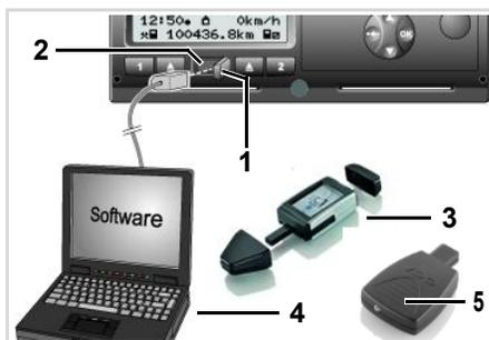
Рис. 51. Подключение к тахографу через интерфейсный разъем
